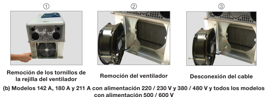
Figura 6.1: (a) y (b) Retirada del ventilador del disipador
